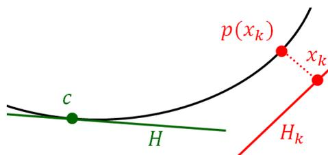
Figure 2: Illustration des hyperplans d'appui  $H_k$  et  $H$ , lorsque la suite  $(x_k)$  tend vers  $c$ .
